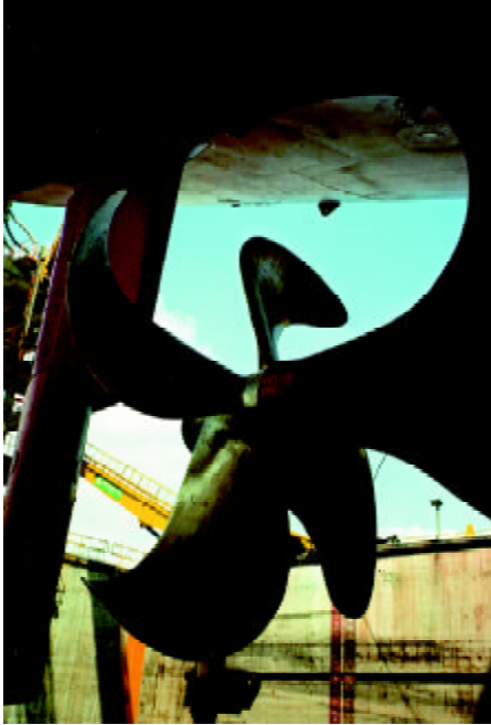
KAPPEL propeller behind the 35000 tdw product carrier M/T Nordamerika of Dampskibsselskabet Norden, A/S
